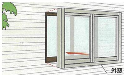
既存窓のガラスと窓枠を取り外し、新たな窓枠を取り付けて、複層ガラス等に交換
