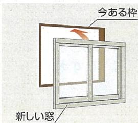
既存窓のガラスを取り外し、既存窓枠の上から新たな窓枠を覆い被せて取り付け、複層ガラス等に交換
