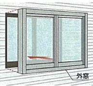
既存窓のガラスと窓枠を取り外し、新たな窓枠を取り付けて、複層ガラス等に交換
